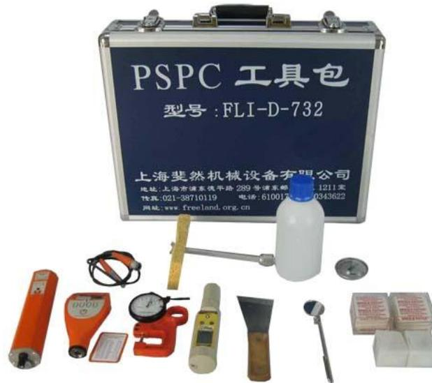
根据 IMO（国际海事组织）制定的有关 PSPC（防腐涂层执行标准），本公司定制了本工具包。包含执行本标准的有关检测仪器，并添加一些辅助工具。方便用户规范检测，全面检测。
