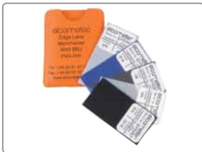
易高990校准膜片是实验室，生产线或现场使用的理想选择。校准片或曰“垫片”是在基体上、加工表面上和外廓上建立厚度标准的最简便方式。这是调节涂层测厚仪校准的最理想方法，以确保最高精确度。
