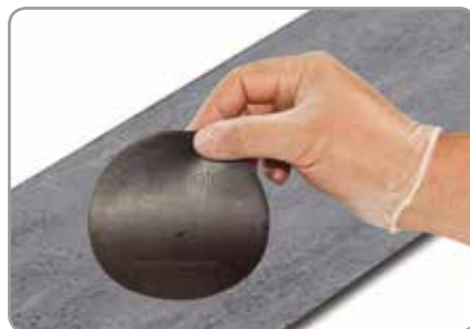
4. 将磁盘, 用湿纸面朝下放在该地区的测试, 用力按到任何轮廓或不规则性, 并启动仪器2分钟计时器。
