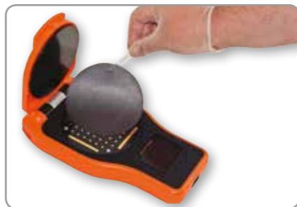
5. 两分钟后, 小心地从测试表面上除去滤纸和磁盘, 并放置到测量电极。
