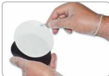
2. 使用镊子, 从包装取出滤纸, 将其放置于所提供的清洁, 非标记磁性盘的一侧。
